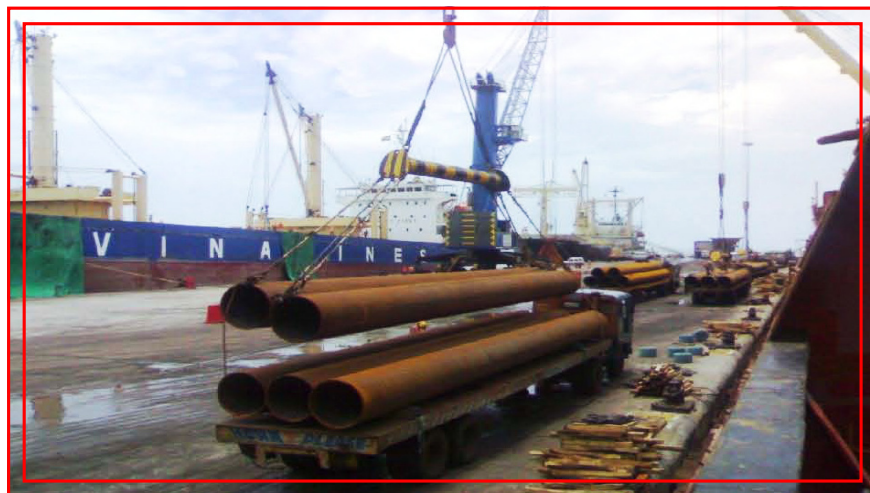
loading لوله ها از روی truck به داخل کشتی
