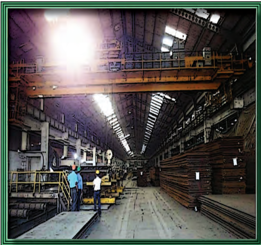
تصویری از ابتدای ورود به LSAW MILL جایی که PLATE ها آماده جهت مرحله بعد تولید میشوند
